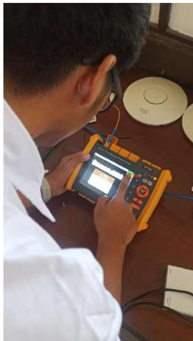
Lampiran 5. 12 Mengecek kelayakan kabel fiber optic menggunakan OTDR
